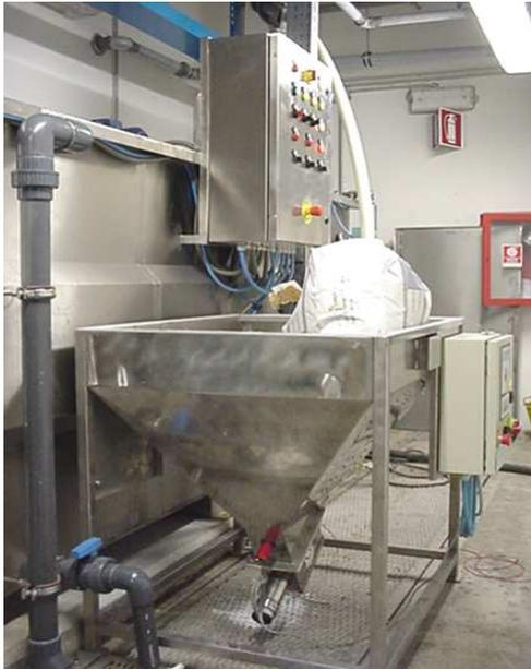
Il **sistema di carico polveri CT** permette di alimentare in modo completamente automatico ed in completa sicurezza il dosatore del polielettrolita.
